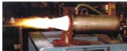
Трехфазный плазменный генератор до 30 kW
