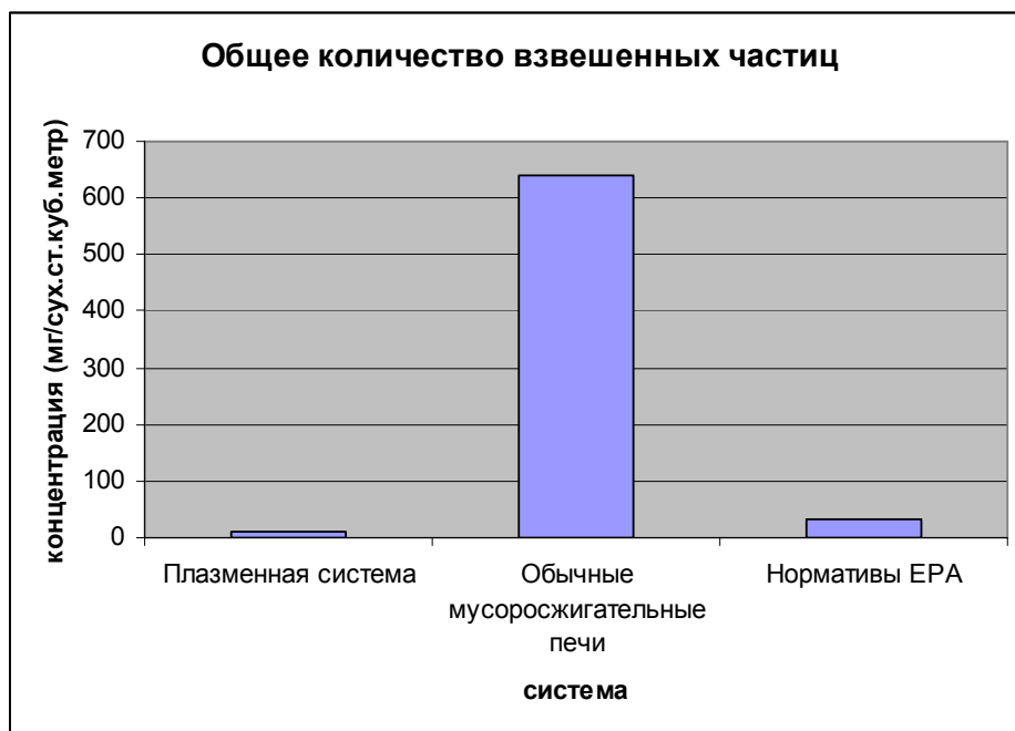
Диаграмма 2. Данные по типичным выбросам частиц, измерения при плазменной газификации опасных отходов.
